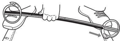
**Montage des arceaux doubles :** Avant le montage, alignez les tubes pour vous assurer qu'ils sont montés correctement, un pied vers le haut et l'autre vers le bas. Placez-vous à l'extrémité de la toile, un pied sur chaque grand tube latéral. Fixez le premier arceau à l'un des grands tubes latéraux à l'aide du crochet qui se trouve sur le pied en nylon.
