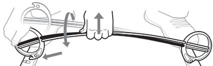
Faites **pivoter** l'autre pied de 180 degrés, jusqu'à ce que le crochet soit du côté de la toile. Tout en tirant le centre de l'arceau d'une main pour l'écarter de la toile, appuyez sur le second pied de l'autre main pour l'accrocher.
