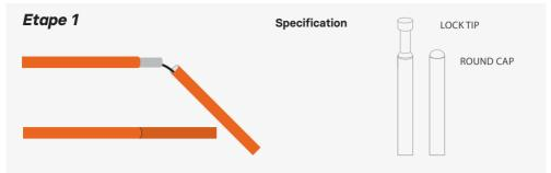
Insérez les tiges les unes dans les autres en veillant à ce que la partie étroite s'intègre entièrement dans l'autre partie. / Insert the poles into each other, making sure that the narrow part fits completely into the other part.
