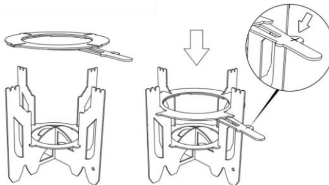
**Insertion du réchaud à alcool EMO :** Insérez le poêle par le haut, perpendiculairement à l'axe du support. Le réchaud doit s'insérer dans le support et rester fermement fixé à l'anneau de fixation. À ce stade, l'ORIGAMI est assemblé et prêt à être utilisé pour cuisiner. N'utilisez jamais qu'un réchaud à alcool EMO intact et en parfait état de marche.
