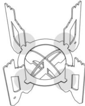
**Assemblage du régulateur :** S'il est également nécessaire de placer un régulateur de puissance mécanique, il suffit de le placer sur le support assemblé (sans le poêle). Comme pour l'anneau de fixation, il faut veiller à faire glisser les quatre rainures sur le support (peu importe quelle rainure se glisse à quel endroit).
