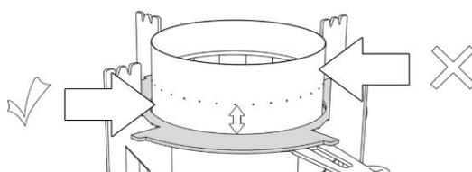
Le niveau supérieur du régulateur ne doit pas couvrir les buses ou atteindre une hauteur supérieure.
