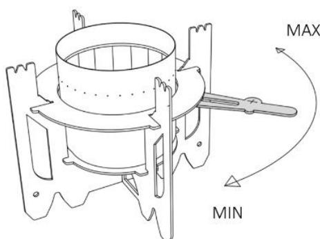
La poignée de commande du régulateur peut être déplacée et réglée en douceur de la position maximale à la position minimale et vice versa. Lors de ce mouvement, l'ensemble du régulateur se déplace de haut en bas. Pour un fonctionnement correct, il est nécessaire de s'assurer que le régulateur ne dépasse jamais le niveau inférieur des buses à la puissance minimale (c'est-à-dire lorsqu'il est en marche).
