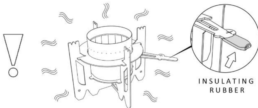
Une chaleur rayonnante invisible est générée autour de l'ensemble de l'assemblage pendant la combustion !
