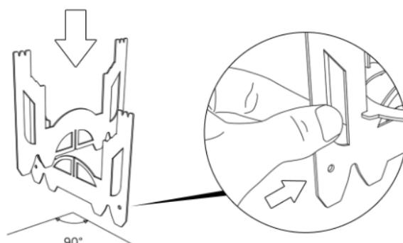
Fixez ensuite la partie C (anneau de fixation) par le haut, qui doit reposer sur la partie inférieure du support.
